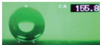
撥水角(接触角)155.8° 超撥水の状態です 超撥水とは接触角150度以上を 言います
