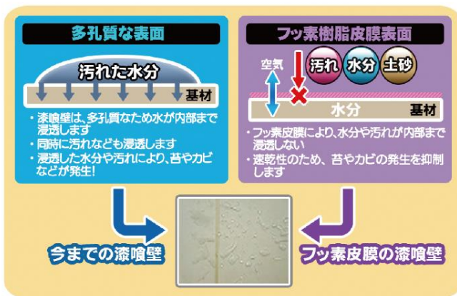
木材や、石材に含んだ水分が漆喰壁等に 移行してカビ、藻が発生します。
